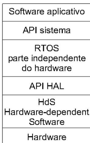
**Figura 2.14. Interfaces padronizadas de software**
